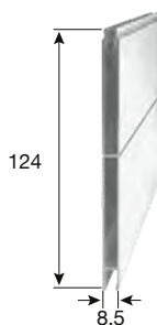
Plný profil P9279 124 x 8,5 mm / d: 6000 mm, 6500 mm
